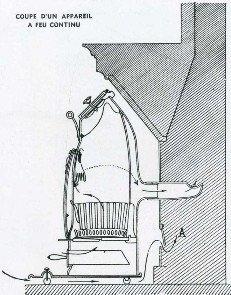
Nota : Quand l'appareil marche au ralenti l'appel d'air de la cheminée passe par la valve de réglage A. ménagée dans la plaque extensible spéciale ou dans le coffre support.
